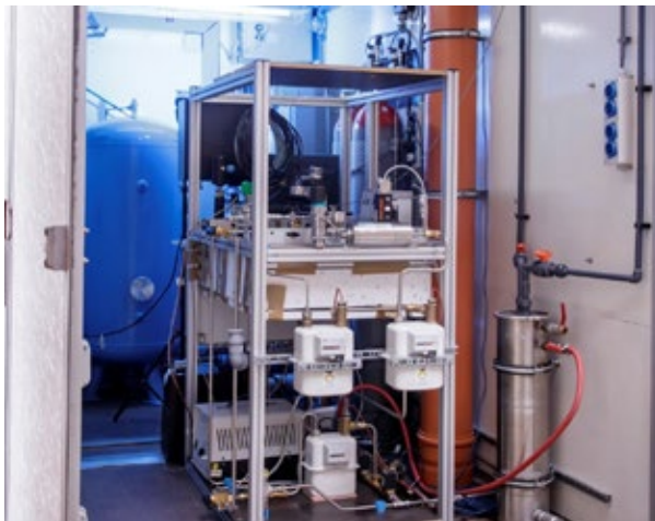
Eine mobile Pilotanlage sorgt für die effiziente Abtrennung von CO 2 vor Ort.
