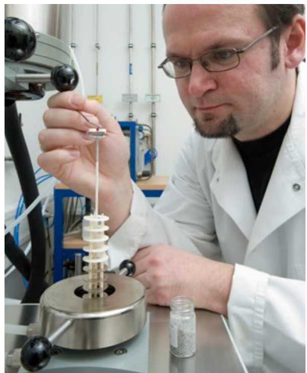
Viel Fingerspitzengefühl benötigt: Ein Forscher bei der Vorbereitung der thermogravimetrischen Analyse zur Bestimmung der CO 2 -Aufnahmekapazität.
