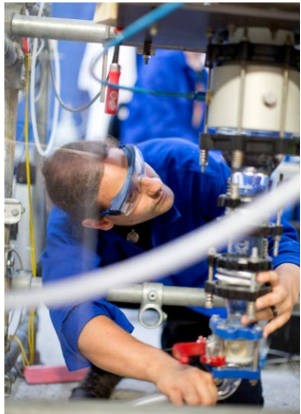
Kernstück des Projektes ist die Methanolsynthese in einem innovativen Blasensäulenreaktor.
