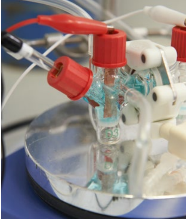
In einer H-Typ Elektrolysezelle werden Katalysatoren vorcharakterisiert.
